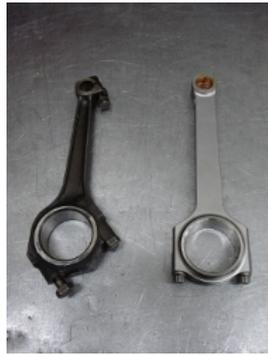
nach Kurbelwellenbruch, wurde eine neue, verstärkte konstruiert
