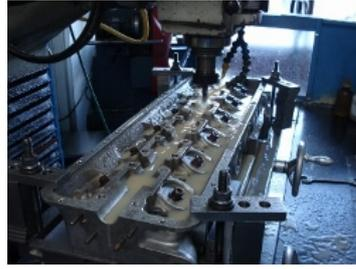
und nachher von Hand eingepasst (geschabt), Kopf bei Ventilsitzbearbeitung
