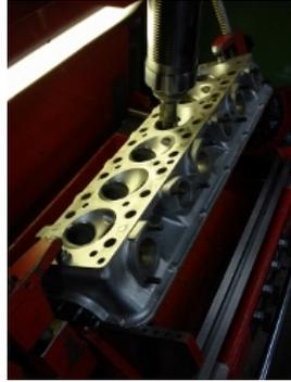
Block auf Bohrwerk beim Deck bearbeiten für den Zylinderbüchsenvorstand
