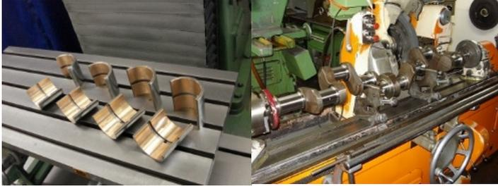
fertig bearbeitete Pleuel, neuer Kolben aus eigenem Gussrohling produziert
