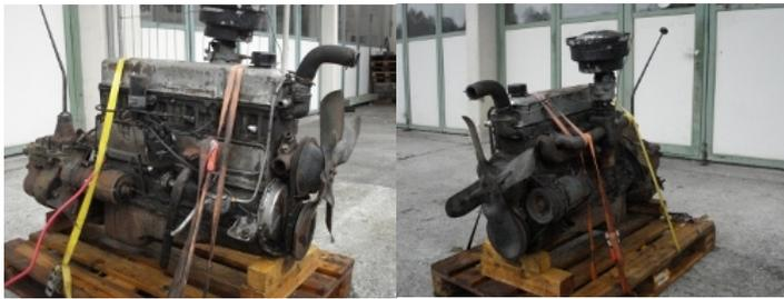
Motor/ Getriebe nach abgeschlossener Revision, bereit zum Einbau
